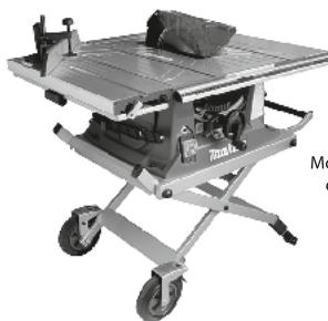
Eine präzise Tischkreissäge mit starkem 1.500 W Motor. Mit einem Sägeblattdurchmesser von 260 mm erreicht die Maschine eine Schnittleistung von 91 mm bei einem 90°-Winkel und 63 mm bei einem 45°-Winkel. Der großzügige klappbare Tisch aus Aluminium-Druckguss verfügt über Räder und Handgriffe zum leichten Transport.
